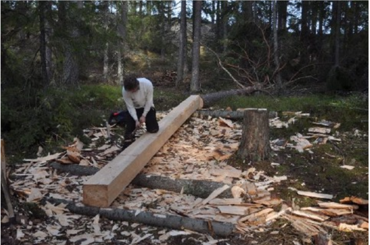
Här läggs sista handen vid sprätthuggningen av fyrkantsblocket. Skarpa kanter och exakthet präglar det medeltida trähantverket. Från blocket kan både sparrar eller brädor klyvas. Stocken är 7 meter lång.
