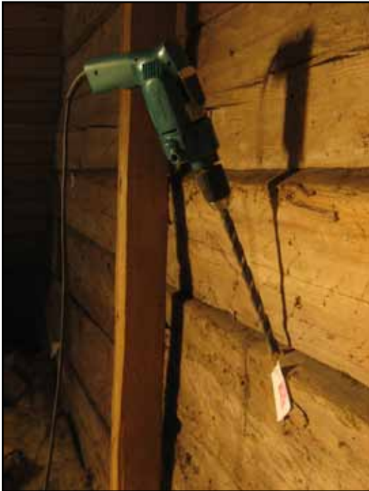
Dendrokronologisk provtagning i östra gavelröset på Mellby kyrka, november 2010.
