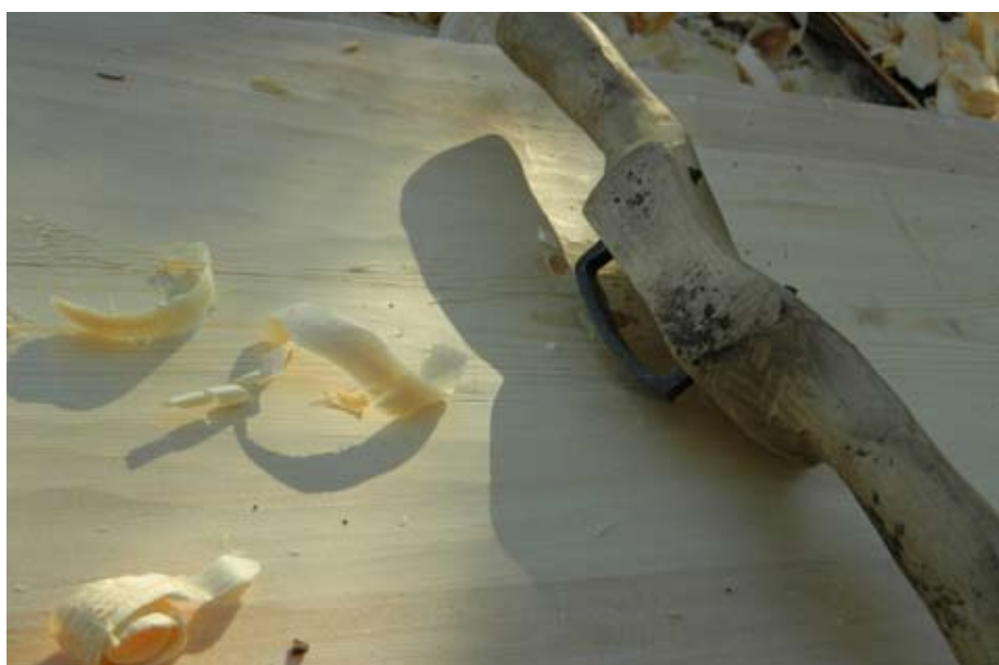
En nytillverkad skave, en enkel form av hyvel. Skaven är tillverkad till Södra Råda gamla kyrkas rekonstruktion.
