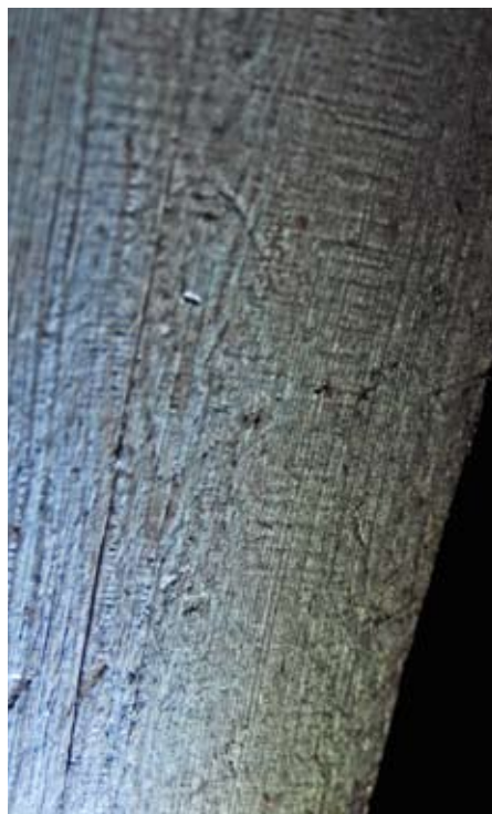
Vibrationsspår efter hyvel/skave på stapelns stomme.
