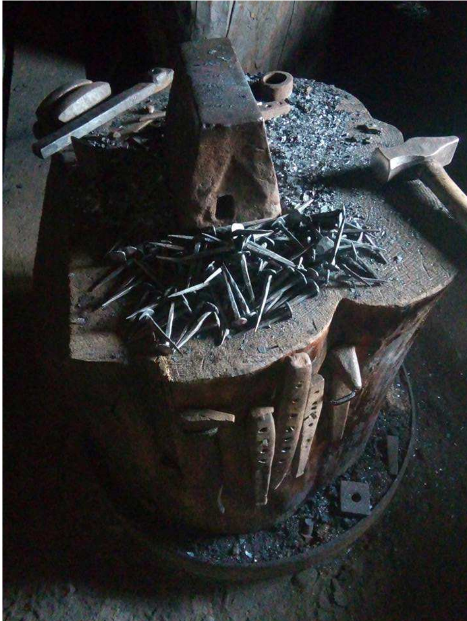
Fig. 37 Produktion av spik för rekonstruktionen av Södra Råda gamla kyrka.
