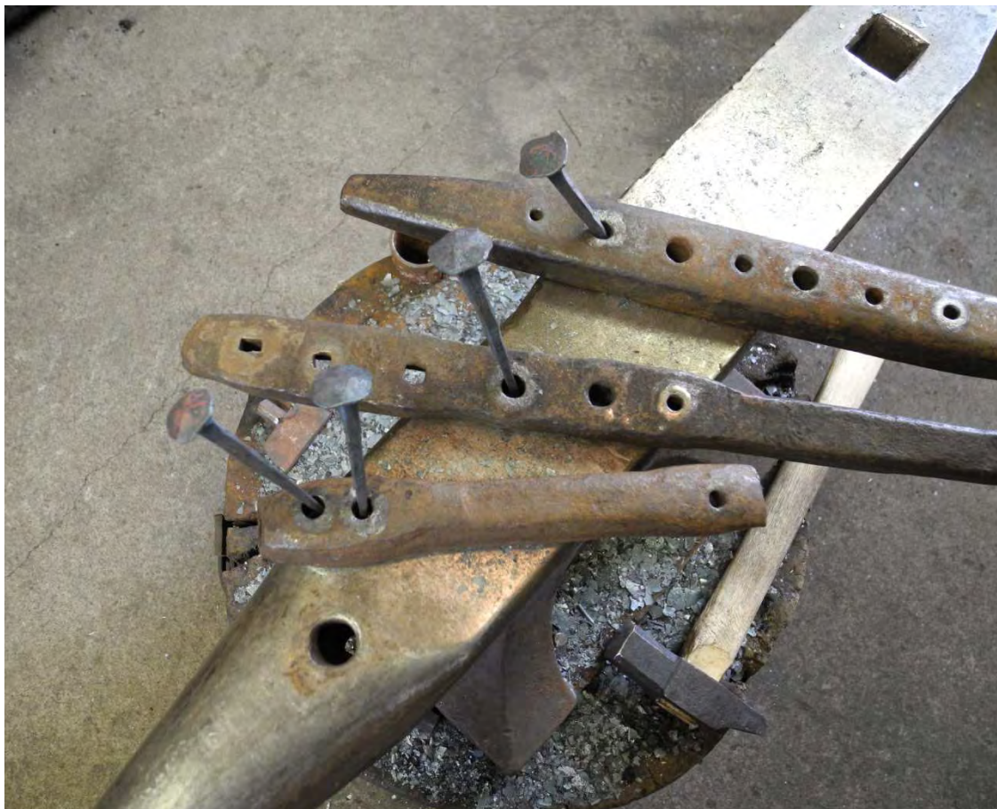
Fig. 31 Smidesförsök. Utprovning av nageljärn. Nageljärnet i mitten kommer från Dalsland, de två andra från Lima, Dalarna.
