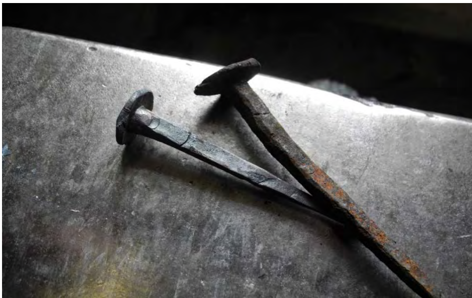
Fig. 32 Spikar typ 1, original och kopia med verktygsspår.
